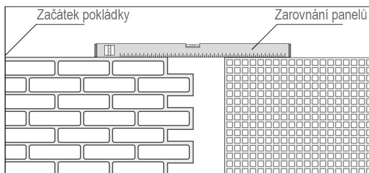
Rozměry panelu upravíme odstrížením - nejlépe nůžkami. Zed' by měla být očištěna od předchozích nátěrů, špiny a prachu, protože lepidlo nedrží dobře na prašném povrchu. Doporučujeme před nanesením panelů napenetrovat zed'. Při lepení si dejte pozor, aby panely byly ve stejně linii - viz. obrázek.
